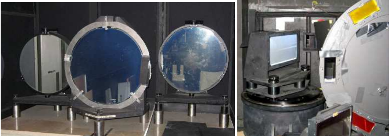
Chambre et collimateur du spectrographe; réseau et filtres sélectionneurs d'ordre
