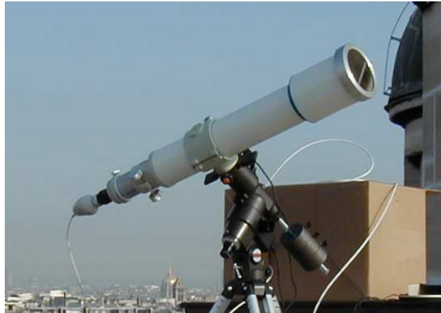
Webcam au foyer d'une lunette munie d'un filtre pleine ouverture
