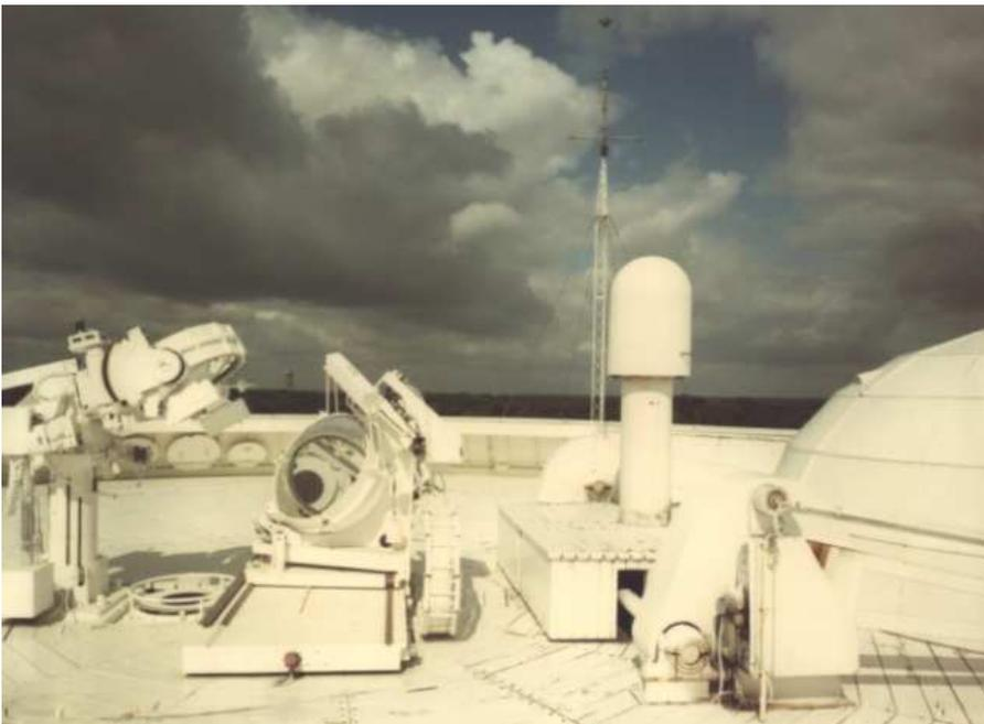
Le coelostat sur la terrasse. Un dôme amovible permet d'abriter le coelostat quand il n'est pas utilisé. Toutes les pièces sont peintes en blanc pour réduire l'échauffement du aux rayons solaires. Le miroir primaire est monté sur rails pour être décalé vers l'est ou l'ouest.
