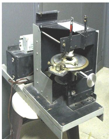
Les clichés de la couronne solaire monochromatique étaient mesurés photométriquement en effectuant des balayages circulaires autour du disque solaire pour mesurer la densité de 5° en 5°. Un disque étalonneur produisait sur la plaque des plages circulaires d'intensités croissantes connues.
